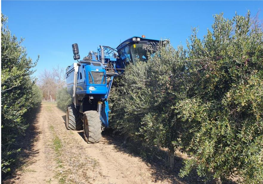
**Foto3: Operación de recolección mecanizada realizada en ensayo en seto con diferentes manejos de riego y variedades en Finca La Orden, Guadajira (Badajoz).**
